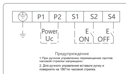
Схема подключения YCM1-400,630,800,1250,1600
