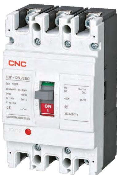
[Серия YCM1](#) – Автоматический выключатель в литом корпусе разработан и производится в соответствии с передовыми мировыми технологиями. Является самой простой и бюджетной версией. В серии имеется термомангнитный или магнитный расцепитель без регулировок. Возможно исполнение с защитой от токов утечки. Корпус выполнен из пластика DMC (Пастообразная формовочная масса, содержащая в большом количестве волокнистый наполнитель). Выполнен согласно стандартам ГОСТ IEC 60947-2-2021, GB14048.2.
