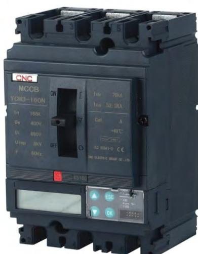
[Серия YCM3](#) – топовая серия автоматических выключателей в литом корпусе. В серии имеются магнитный, термомангнитный, электронный, электронный(интеллектуальный) расцепители. С регулировками. Отличается особой конструкцией силовых контактов, таких как «коромысло» с двойным разрывом цепи. Возможна установка модуля с защитой от токов утечки. Корпус выполнен из пластика PC (Поликарбонат (ПК); полихлоропропен). Выполнен согласно стандартам ГОСТ IEC 60947-2-2021, GB14048.2.
